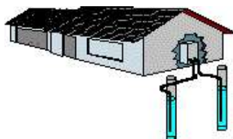
Fig. 14.18. Sistem de încălzire cu buclă deschisă [14.7].
